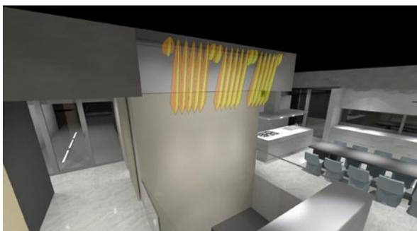
Haus Galm, Osterburken: gleichmäßige Wandflutung durch ausrichtbare LED-Strahler mit Spot- und Floodoptiken, Darstellung mit eingeblendeten Lichtverteilungskurven.
