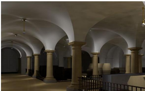
Graft Berliner Dom: Überprüfung der Lichtwirkung und möglicher Leuchtenpositionen in der Simulation.
